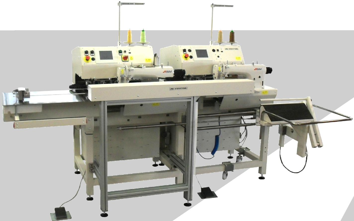
**IT** L'unità automatica **JT884P** è una macchina automatica ad area programmabile per l'applicazione di tasche prestirate a toppa su jeans e simili, con scaricatore automatico.
